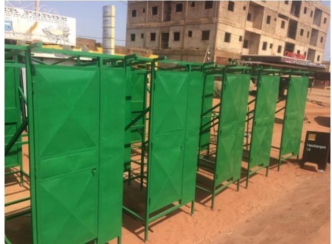
Porte d'entrée des structures ferronnées des latrines
